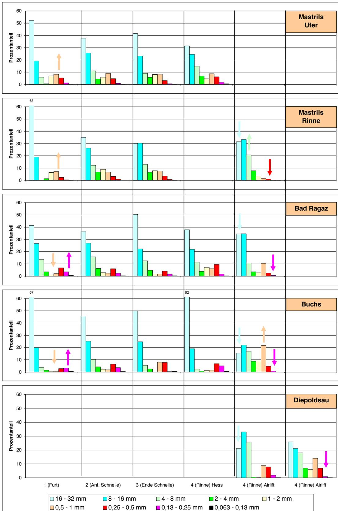
Abb. 4: Sedimentanalysen. Häufigkeitsverteilung der verschiedenen Korngrößenklassen. Pfeilmarkierungen: auffallende Unterschiede im Vergleich der verschiedenen Teststrecken und Probenbereiche (nur beim Bereich 1 und den Airliftproben eingezeichnet):
