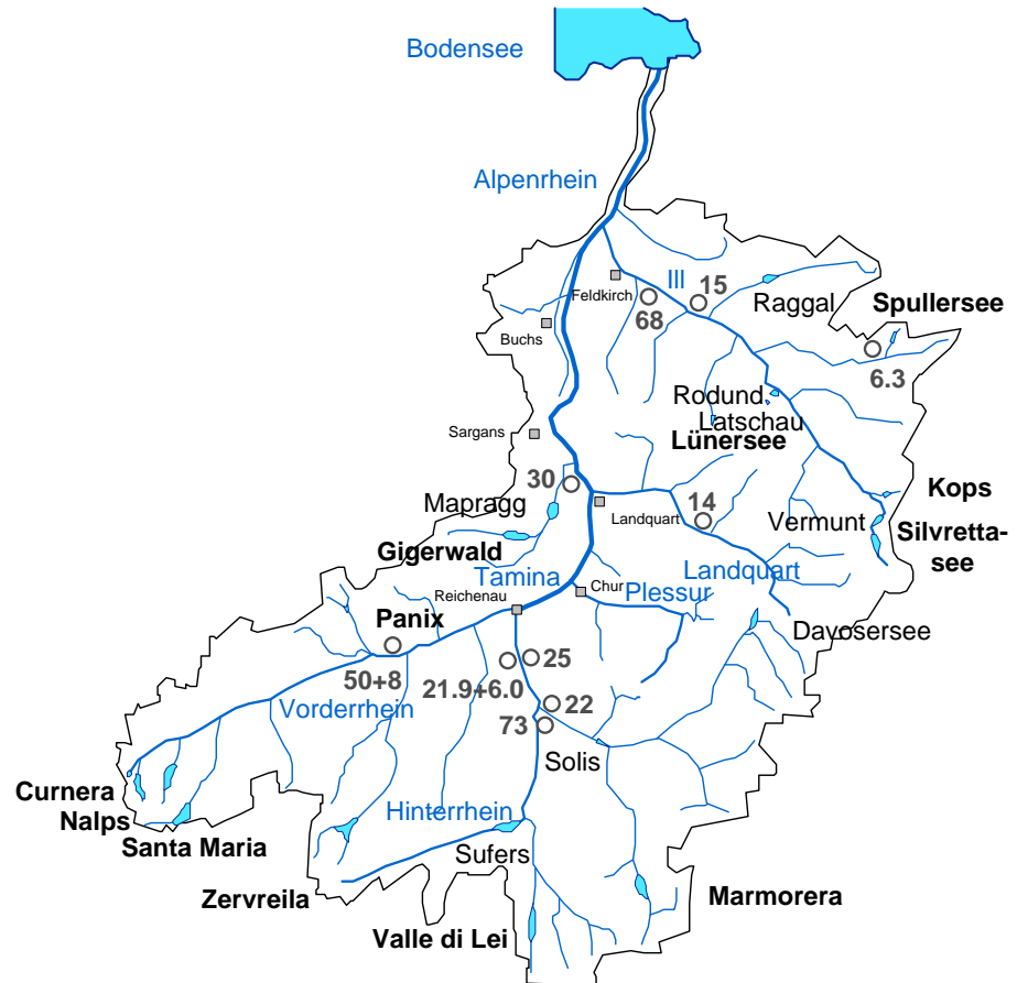
Bild 9: Einzugsgebiet des Alpenrheins mit den Standorten der grossen Speicherseen (fett) sowie den Zentralen mit den installierten Turbinenleistungen in m 3 /s.
